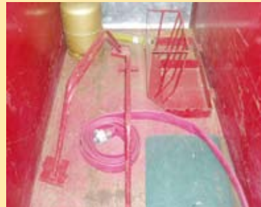
Vue intérieure. La bouteille de gaz sert à chauffer l'eau à 38°
